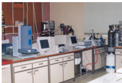
Σχ. 1. Συσκευή STA 449C JURITER του οίκου NETZSCH η οποία συνδυάζει τις τεχνικές TG/DTG, DTA και DSC (δεξιά) και θερμιδομετρο, μοντέλο C80 του οίκου SETARAM (αριστερά).
