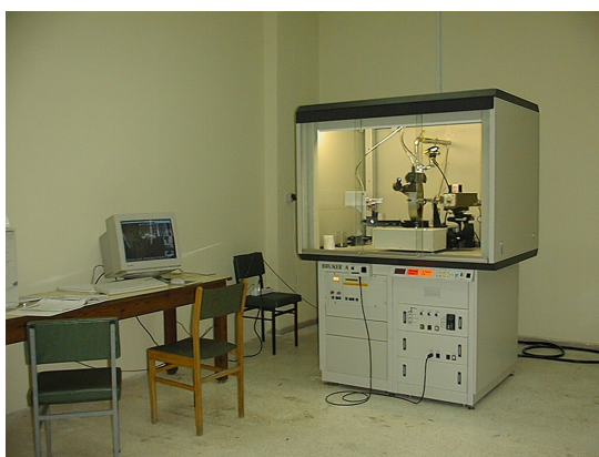
Σχ. 1. Περιθλασίμετρο XRD μονοκρυστάλλου τεσσάρων κύκλων, τύπου P4 της Bruker.
