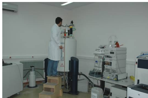
Σχήμα 3. Γενική άποψη του φασματογράφου Brüker AV-500 (συχνότητα συντονισμού ^1\text{H} 500 MHz) συζευγμένου με σύστημα LC-SPE-NMR. Το σύστημα φέρει τον υποδοχέα κρυογενικής τεχνολογίας.
