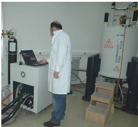
Σχήμα 4. Κρυογενική μονάδα για τον υποδοχέα κρυογενικής τεχνολογίας του φασματογράφου Bruker AV- 500 (συχνότητα συντονισμού ^1\text{H} 500 MHz)
