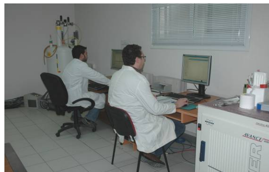
Σχήμα 1. Γενική άποψη του φασματογράφου NMR Brüker Avance AV-250 (συχνότητα συντονισμού ^1\text{H} 250 MHz).
