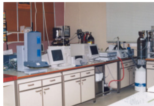
Σχήμα 1. Συσκευή STA 449C JURITER του οίκου NETZSCH η οποία συνδυάζει τις τεχνικές TG/DTG, DTA και DSC (δεξιά) και θερμιδόμετρο, μοντέλο C80 του οίκου SETARAM (αριστερά).
