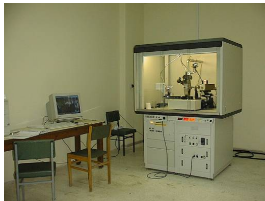
Σχήμα 1. Περιθλασίμετρο XRD μονοκρυστάλλου τεσσάρων κύκλων, τύπου P4 της Brüker.
