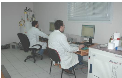
Σχήμα 1. Γενική άποψη του φασματογράφου NMR Brüker AV-250 (συχνότητα συντονισμού ^1\text{H} 250 MHz).
