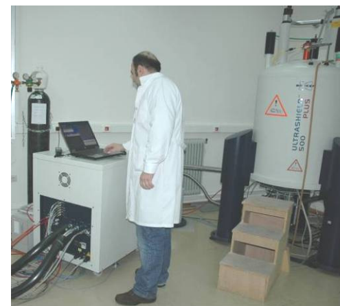
Σχήμα 4. Κρυογενική μονάδα για τον υποδοχέα κρυογενικής τεχνολογίας του φασματογράφου Brüker AV-500 (συχνότητα συντονισμού ^1\text{H} 500 MHz).
