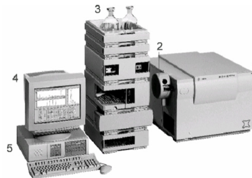
Σχήμα 1. Γενική άποψη του φασματοφωτομέτρου μαζών (Hybrid MS/MS) της εταιρίας Micromass
