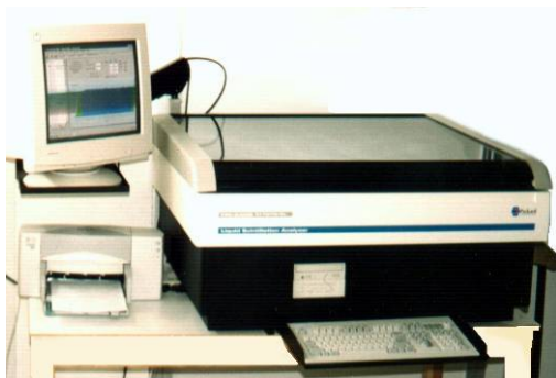
Σχήμα 1. Μετρητής υγρού σπινθηριστή Tri-carb 3170TR/SL χαμηλού υποβάθρου.
