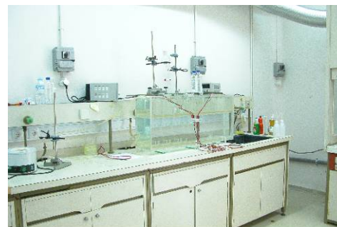
Σχήμα 3. Συσκευή ηλεκτρόλυσης για τον εμπλουτισμό δειγμάτων ύδατος σε τρίτιο.
