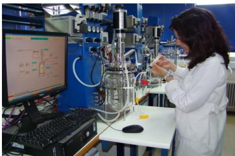
Σύστημα βιοαντιδραστήρων (τύπος RALF-Bioengineering) του Ερευνητικού Κέντρου Αθηροθρόμβωσης. Το σύστημα χρησιμοποιείται για τη βιοτεχνολογική παραγωγή βιοδραστικών μεταβολικών προϊόντων.
