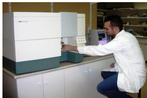
Κυτταρόμετρο ροής (τύπου FACS Calibur) του Ερευνητικού Κέντρου Αθηροθρόμβωσης. Το όργανο χρησιμοποιείται για τη μέτρηση και την ανάλυση πολλαπλών φυσικών χαρακτηριστικών των κυττάρων.
