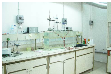
Σχ. 3. Συσκευή ηλεκτρόλυσης για τον εμπλουτισμό δειγμάτων ύδατος σε τρίτιο.
