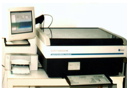
Σχ. 1. Μετρητής υγρού σπινθηριστή Tri-carb 3170TR/SL χαμηλού υποβάθρου.
