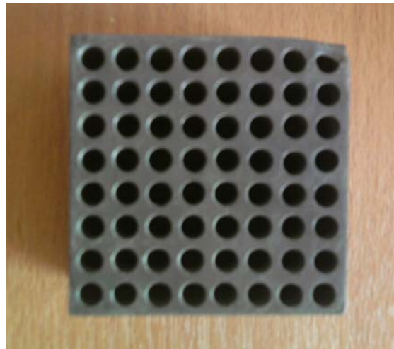
Σχήμα 7.2: Ο κατευθυντήρας παραλλήλων οπών που χρησιμοποιήθηκε κατά την ακτινοβόληση του διακριτοποιημένου κρυστάλλου CsI(Tl) από 3 ραδιενεργές πηγές.
